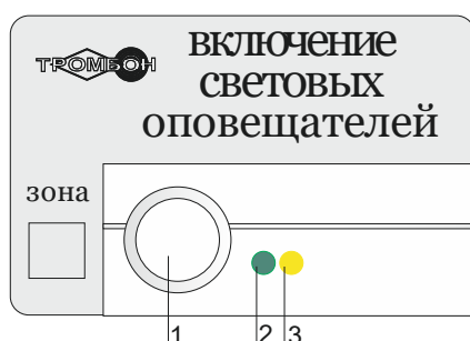
Рис. 3 Эскиз удалённого выключателя светового оповещения «Тромбон ВСО»
