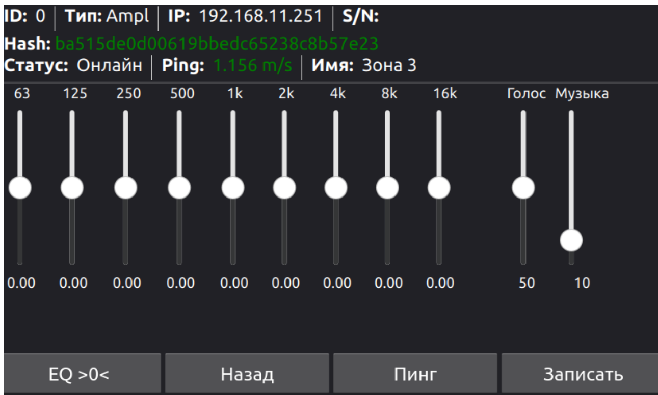
Рисунок 34 - Настройки другого функционального блока на примере «Тромбон IP-УМ120»
